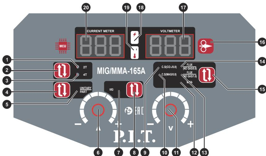
1. Индикатор режима сварки 2Т. В режиме 2Т нажатие кнопки управления горелкой запускает процесс сварки, отпускание — прерывает.
