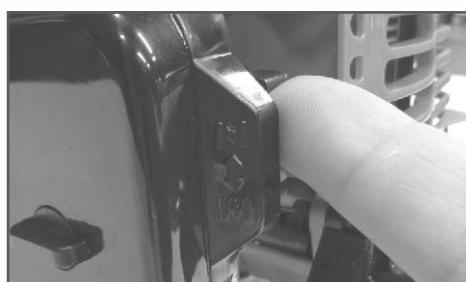
5. Выключатель зажигания (A) установите в положение «I». Удерживая предохранительный рычаг (C) нажмите на курок газа (D). Для облегчения запуска зафиксируйте курок газа стопором (B).
