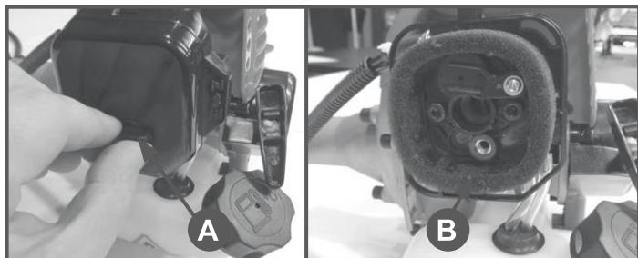
Открутите винт–барашек крышки воздушного фильтра, снимите крышку воздушного фильтра (A) и извлеките фильтрующий элемент (B). Поролоновый фильтр промойте в теплой мыльной воде, отожмите и просушите. Перед установкой поролоновый фильтр смочите чистым моторным маслом. Лишнее масло отожмите. Поврежденный или сильно загрязненный фильтр необходимо заменить.
