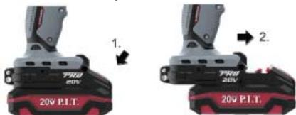
Чтобы извлечь аккумуляторную батарею , нажмите на кнопку разблокировки и извлеките аккумулятор из электроинструмента.
