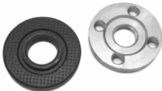
верхняя гайка-фланец никелированная, серебристого цвета, нижняя шайба упорная – черного цвета с шероховатой структурой, что повышает надежность фиксирования диска, одновременно увеличивает эффективность работы и снижает чувство вибрации в руках во время работы.
