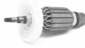
– внутренняя часть выполнена способом полностью автоматического накручивания нити, вокруг ротора добавлена сетка, препятствующая попаданию на эмалевые провода пыли, мелких камней и других инородных тел (эмалевый провод выполнен из медной проволоки, обладает устойчивостью к высоким температурам до 180°C), что увеличивает срок службы ротора. Содержание серебра в коммутаторе 8/10000, что делает поверхность коммутатора более гладкой, увеличивая срок эксплуатации.
