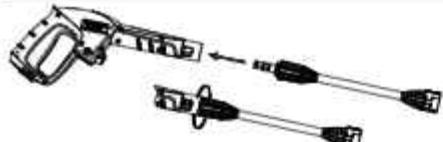
2. Для прикрепления распылительного сопла(Н) вставьте его в удлинитель(Г), и приложите достаточное усилие при нажатии до характерного щелчка. Проверьте надежную фиксацию сопла.
