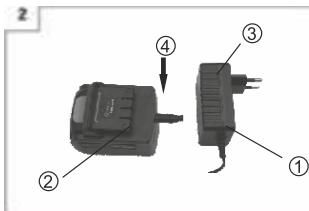
Подключите зарядное устройство(1) в розетку, светодиод начнет светиться зеленым цветом, штекер(2) установите в гнездо зарядки батареи(3), предварительно сняв батарею с
