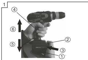
1. Чтобы снять батарею(3), удерживайте инструмент за рукоятку и нажмите на кнопку фиксатора аккумулятора (2)
